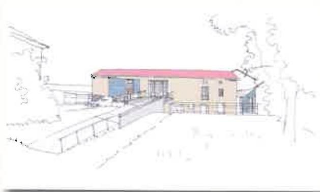
Les travaux de la tranche I ont commencé et se termineront fin février 2016. Ils comprennent le gros œuvre, charpente en bois et couverture en tuiles, menuiseries extérieures en aluminium, serrurerie et rampe d'accès.
